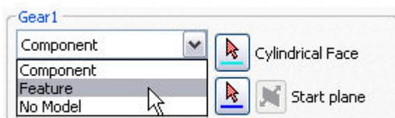
6. Selecteer **Component** in het uitklapmenu van de **Gear 2** rubriek. Het tweede tandwiel wordt als een nieuw onderdeel toegevoegd aan je *assembly*.
